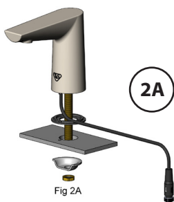
Single Hole Deck Mount Montaje sobre cubierta con un solo orificio Montage sur le plan de travail avec trou unique Arbeitsplattenbefestigung mit Einlochmontage 单孔台式安装
