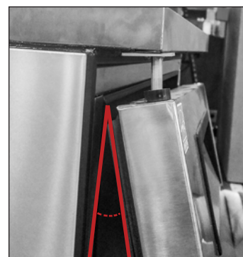
Fig. 10. Si nécessaire, utilisez uniquement des petits angles pour positionner la porte.
