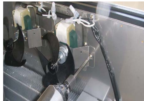
B. Remove the evaporator fan motor
