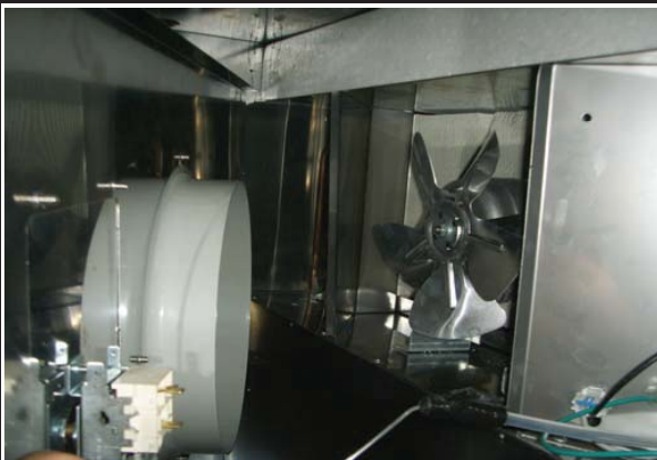
D.Disassemble the evaporator fan motor
