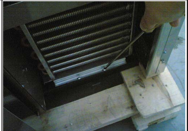
E.Disassemble the condenser fan motor
