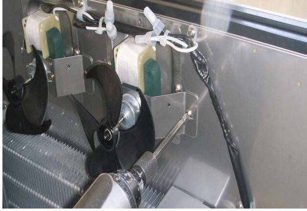
B.Remove the evaporator fan motor
