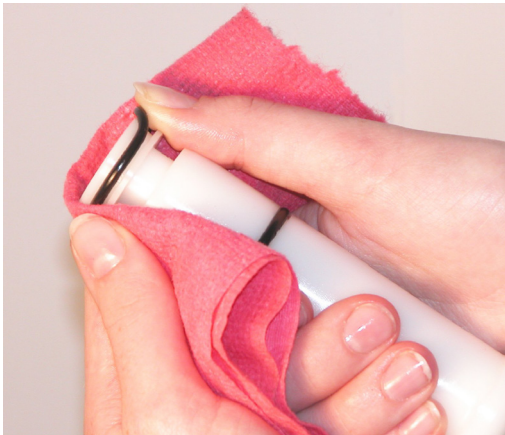
Figure 3-6 Enlèvement du joint torique
