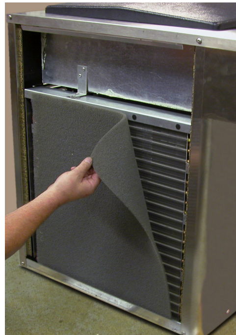
Figure 3-11 F112 Enlèvement du Filtre du Condenseur
