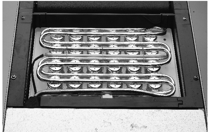
Pour Scale Remover Over The Evaporator Section
