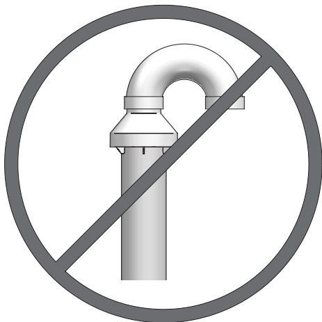
Figure 5-5 Ne pas installer un coude en U au chapeau pare-pluie
