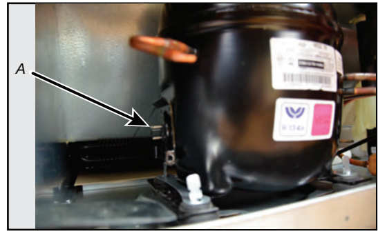
A. Compressor terminal
