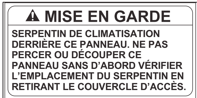
Figure 6 – Étiquette d'avertissement sur le plénum
