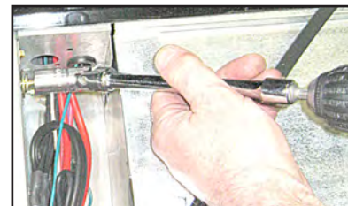
Utiliser une douille avec un adaptateur réglable à joint universel pour serrer plus facilement les fixations.
