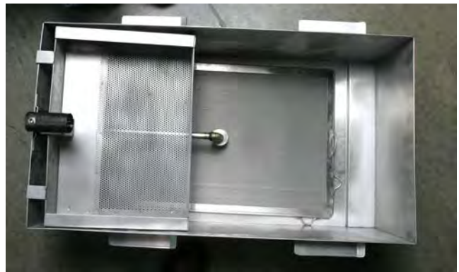
Plateau ramasse-miettes placé correctement dans le bac du filtre.
