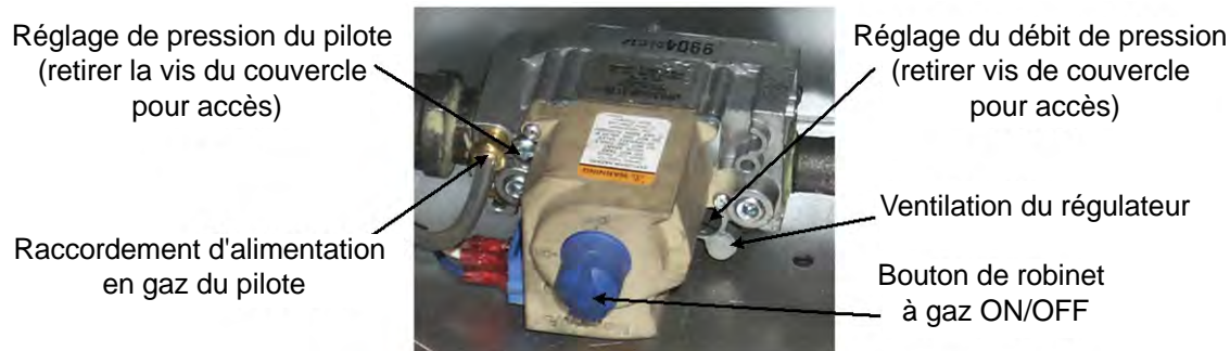
Soupape à gaz typique non CE pour les friteuses avec ignition électronique.
