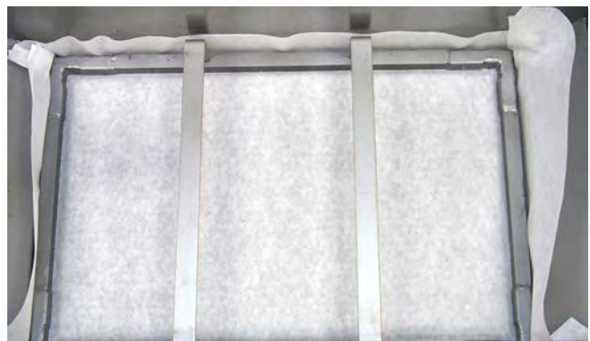
Bague de retenue correctement positionnée sur le papier filtre dans le bac de filtre.
