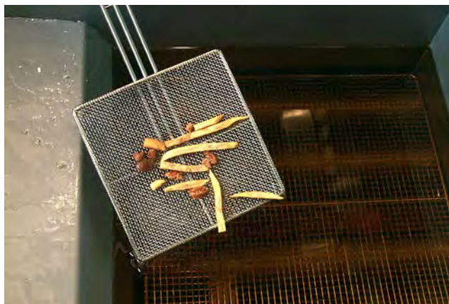
Avant le filtrage, écumer les gros débris de l'huile dans la cuve.
