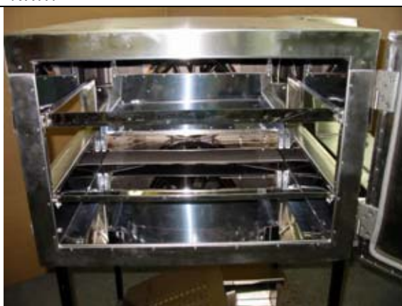
16. Intérieur avec les deux diffuseurs enlevés.
