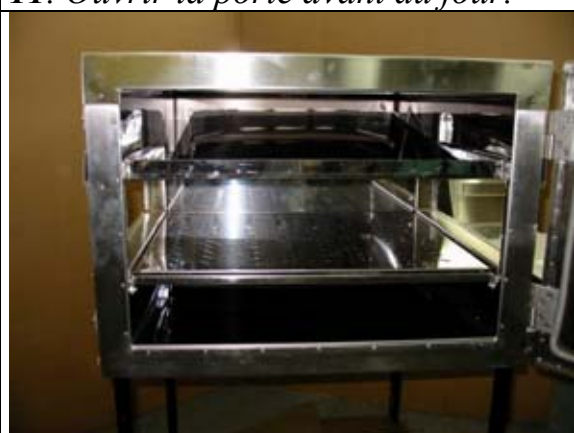
12. Enlever les diffuseurs de chaleur.
