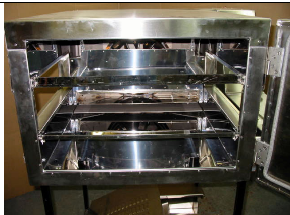
16. Intérieur avec les deux diffuseurs enlevés.
