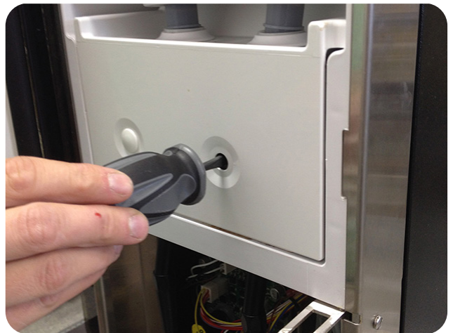
Réglage du débit d'eau À l'aide d'un tournevis à lame plate
